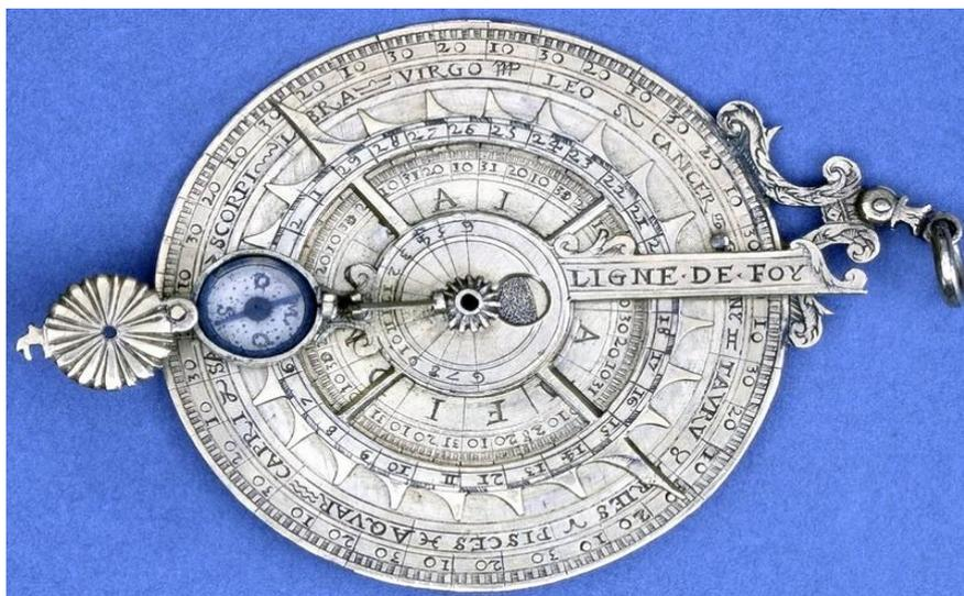
4. **Планисфера** до XVII века использовалась как основной инструмент для определения моментов восхода и захода различных небесных светил. По сути планисфера представляет собой координатную сетку, нанесённую на металлический диск, около центра которого вращается алидада. Изображение небесной сферы на плоскости могло быть либо в стереографической, либо в азимутальной проекции.
