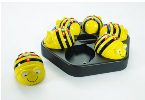
Рис. 1.3. Программируемый робот Bee-Bot.
